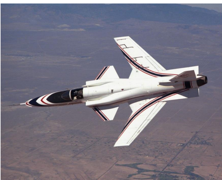
Figuur 36: Vliegtuig waarin koppelingseffect doelbewust is 'ingebouwd'
