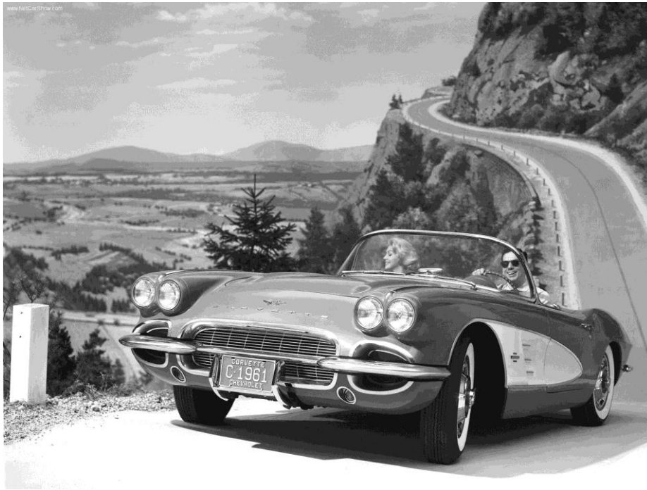
Figuur 2: Chevrolet Corvette uit 1961, met glasvezel carrosseriedelen [1]
