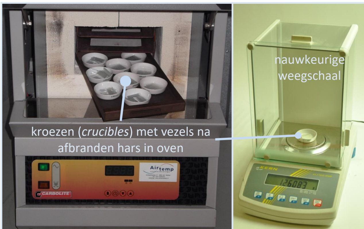
Figuur 68: Benodigdheden voor het doen van vezelvolumengehaltemeting (bron: WMC)
