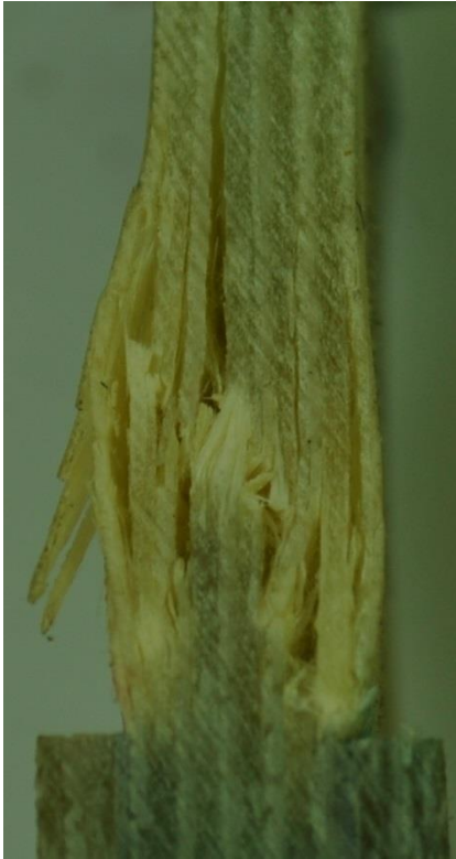
Figuur 28: Knik van lamellen en secundaire delaminatie
