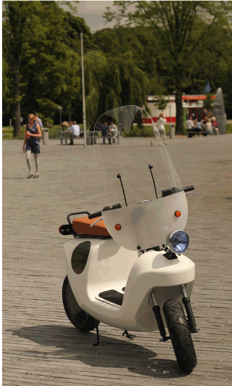
Figuur 59: Deze 'bioscooter', een elektrisch aangedreven scooter gemaakt van biocomposiet, werd mede ontwikkeld door Hogeschool Inholland
