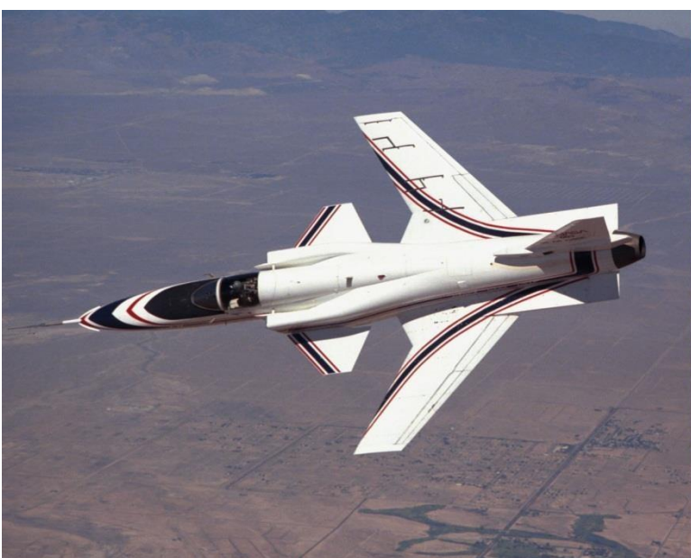
Figuur 36: Vliegtuig waarin koppelingseffect doelbewust is 'ingebouwd'
