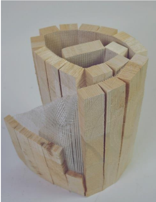
Figuur 16: Kernmateriaal met groeven (bron: WMC)
